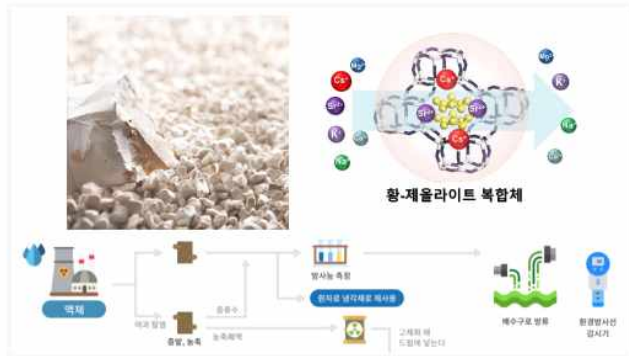
<황-제올라이트 복합체 구조 및 액체방사성 폐기물 처리 과정>
